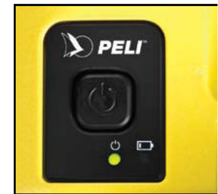
Low battery warning system Système d'avertissement de batterie faible
