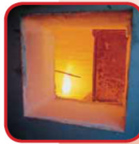
Armoire en cours d'essai après 10 minutes de chauffe. Température du four \pm 720°C
