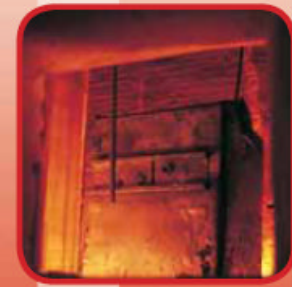
Armoire en cours d'essai après 30 minutes de chauffe. Température du four \pm 930°C
