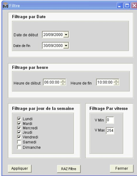
Dans l'exemple ci-dessus, tous les véhicules détectés entre le **20/09/2000** et le **30/09/2000**, entre **6h** et **10h**, du **Lundi** au **Vendredi** roulant à une vitesse comprise entre **0km/h** et **254 km/h** seront conservées.
