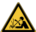
W032: Danger; Déplacement rapide de la pièce à mettre en forme dans une presse plieuse
