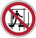
P025: Ne pas utiliser un échafaudage incomplet
