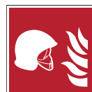
F004B: Ensemble d'équipements de lutte contre l'incendie
