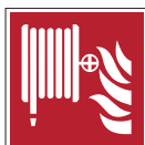
F002: Robinet d'incendie armé
