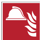
F004: Ensemble d'équipements de lutte contre l'incendie
