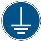
M005: Mise à la terre obligatoire
