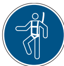
M018: Harnais de sécurité obligatoire
