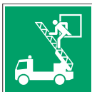
E017: Fenêtre de secours
