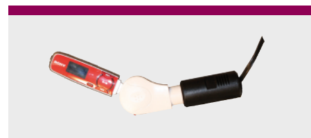
Prise allume-cigare femelle avec chargeur USB, pour charge du lecteur MP3
