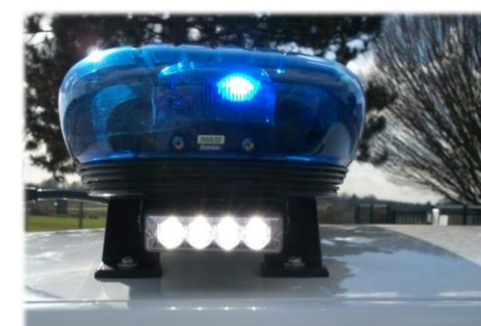
Pieds de fixation en acier noir avec traitement anticorrosif. Réglage de l'angle de la rampe pour une efficacité maximum de la signalisation
