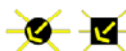
R21c Signal d'affectation de voies qui signifie l'obligation de se rabattre vers la voie adjacente indiquée par la flèche
